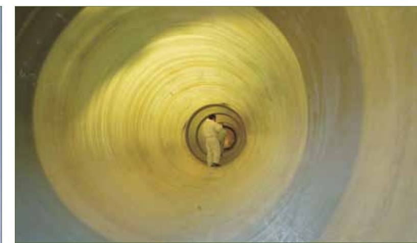
Con 2 metros de diámetro, está hecha de plástico reforzado con fibra de vidrio
