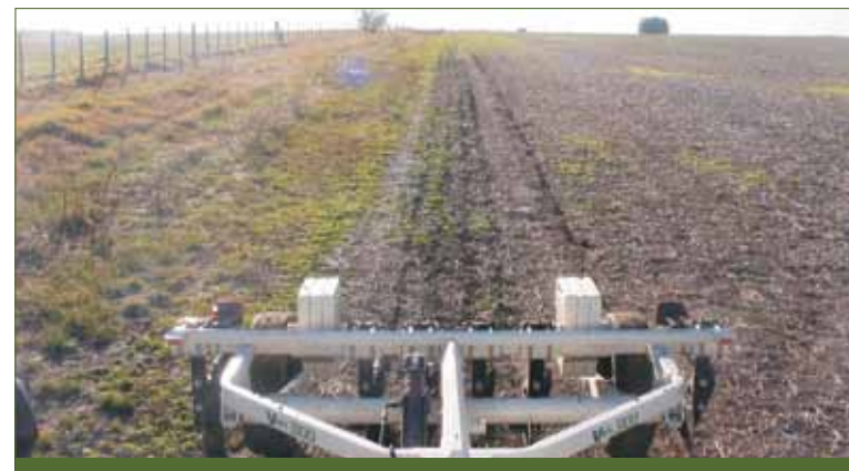
Rastra Sonda Veris, utilizada para medir la conductividad eléctrica del suelo
